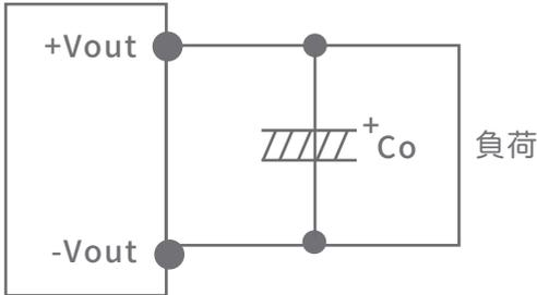
3.5.1 出力端に外部コンデンサを接続する方法
