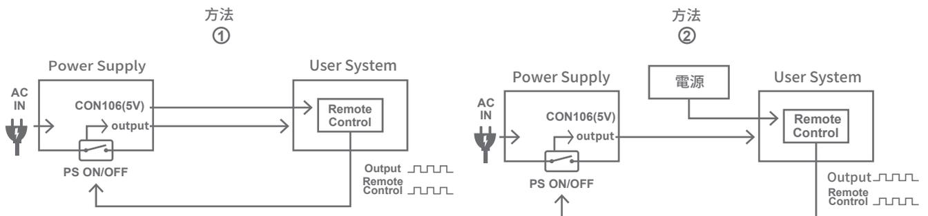
3.2.1 UOHC3150 &UOHC3240 リモートON/OFF回路の使用例
